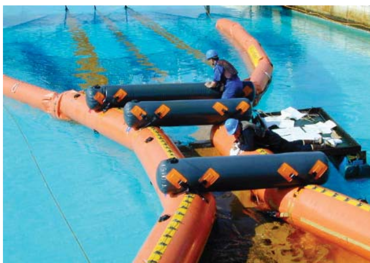
米国沿岸警備隊OHMSETTでの集油テスト
